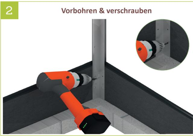
2 | Die Füllungsprofile mithilfe der Löcher (Eckprofile) mit einem 3mm Bohrer ca. 5mm tief vorbohren und mit den beiliegenden 4,2mm Schrauben befestigen.
