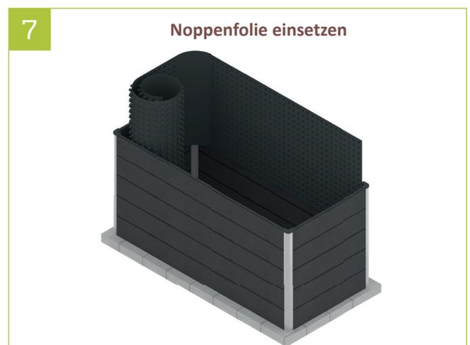
7 | Zur Vermeidung von Staunässe und zum Schutz der Füllungsprofile, empfehlen wir die Verwendung von Noppenfolie (nicht im Lieferumfang enthalten), dabei müssen die Noppen zur Füllungsseite ausgerichtet und die Folie mithilfe eines Tackers angeheftet werden.
