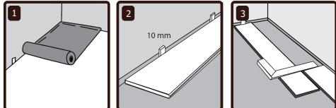
**3** Die letzte Dielie der Reihe ist so umzukehren, dass das Stück, welches noch in diese Reihe passt, mit der Kopfeder zur Wand zeigt. Die hierdurch festgestellte Abkürzungsstelle ist mit einem Winkel quer über die Dielie festzuhalten und abzusägen, und danach ist die Dielie mit der Schnittstelle zur Wand zu verlegen. Vergessen Sie nicht, die Dielie mit einem Abstandskeile zur Stirnwand festzukleben.
