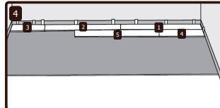
**6** Die nächste Dielie verlegen und beim Kopfeder leicht zu recht schlagen. Einen Schlagklotz mit Ausfräser benutzen oder den Schlagklotz oberhalb des Unterganges platzieren, um die Kopfnut zu schützen.
