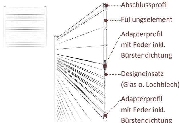
6a | Die Füllungselemente nacheinander von oben einschieben, dabei die Feder der Füllungselemente nach oben ausrichten. Bei der Montage des Designeinsatzes folgende Reihenfolge beachten: Adapterprofil mit Nut, Designelement, Adapterprofil mit Feder. Danach ein Füllungselement einschieben und das Abschlussprofil aufsetzen.
