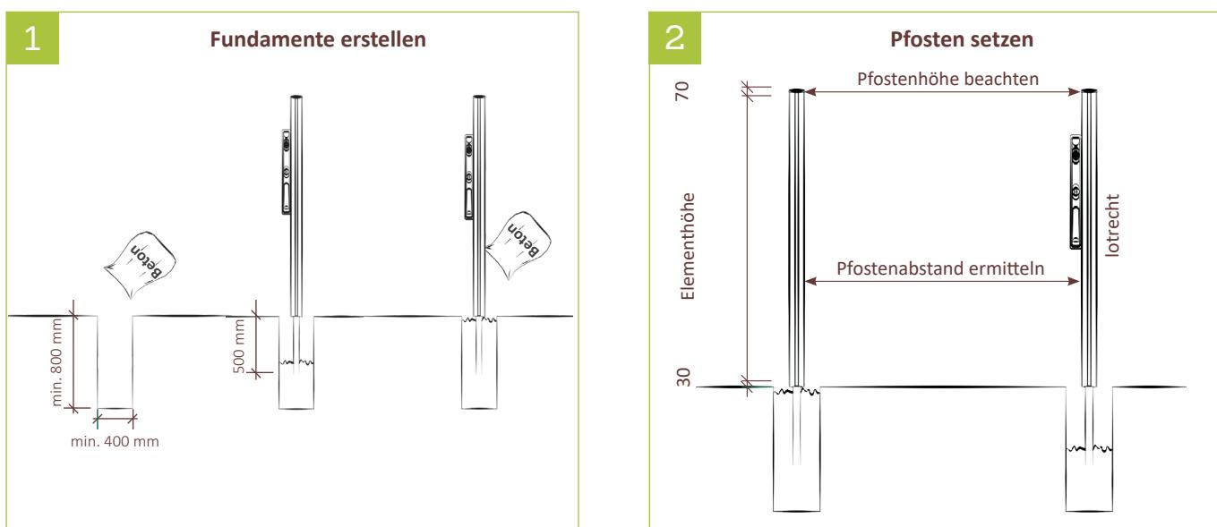
1 | Größe der Fundamente mindestens 400 x 400 x 800 mm sowie unter Berücksichtigung der Bodenbeschaffenheit.\* Ungefähr die Hälfte des Erdloches mit Beton füllen und verdichten. Anschließend die Pfosten setzen und ausrichten. Das Erdloch komplett mit Beton füllen und verdichten.
