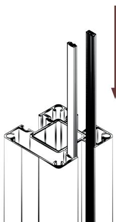
5 | Jeweils zwei der mitgelieferten Bürstendichtungen in die Pfostennuten einschieben.
