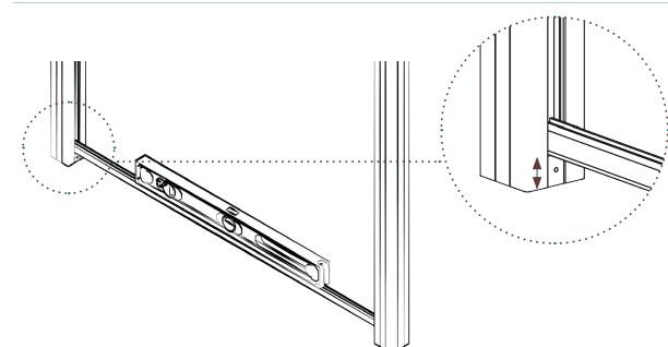
4 | Zuerst auf einer Seite das Distanzstück befestigen. Das Distanzstück der zweiten Seite mit Hilfe der U-Leiste und einer Wasserwaage ausrichten und befestigen.
