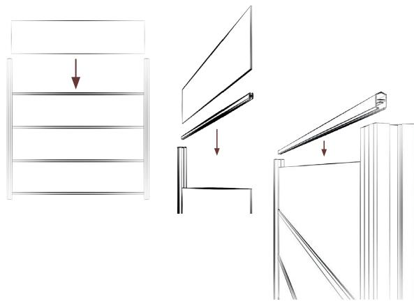
6 | Das U-Profil in die Pfosten von oben einschieben. Danach vorsichtig die Füllungselemente und die H-Profile im Wechsel einsetzen. Mit dem Abschlussprofil abschließen.
