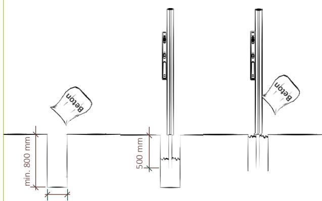
1 | Größe der Fundamente mindestens 400 x 400 x 800 mm sowie unter Berücksichtigung der Bodenbeschaffenheit.\* Ungefähr die Hälfte des Erdloches mit Beton füllen und verdichten. Anschließend die Pfosten setzen und ausrichten. Das Erdloch komplett mit Beton füllen und verdichten.
