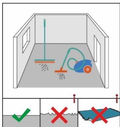
Der Untergrund muss rissfrei, sauber, zug-/druckfest und dauerhaft trocken sein (VOB, Teil C, DIN 18365). Entfernen Sie vor der Verlegung Altbeläge restlos vom Untergrund, soweit diese die Ebenheit des Untergrundes beeinflussen. Die Ebenheit des Untergrundes sollte auf 1 m nicht mehr als +/- 3 mm abweichen (DIN 18202). Lassen Sie ggf. den Verlegeuntergrund durch einen Bodenleger überprüfen.
