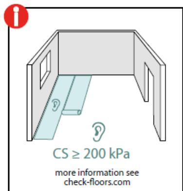
Bitte verwenden Sie eine geeignete Trittschallunterlage für Vinylböden mit einer Druckbeanspruchung von mind. 200 kPa.
