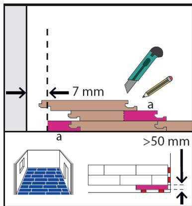
Um die letzte Paneel-Reihe zu montieren, müssen Sie diese auch in der Breite einkürzen (siehe Bild links). Beachten Sie die Dehnungsfuge.
