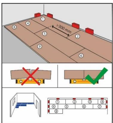
Gehen Sie beim Einsetzen der nächsten Reihen genauso vor. Achten Sie darauf, dass die Paneele absolut bündig zueinander liegen. Achten Sie darauf, dass der Versatz der Kopfstöße von Reihe zu Reihe mind. 30 cm beträgt.
