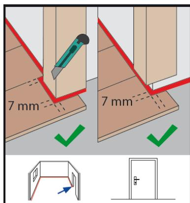
Türzargen aus Holz können gekürzt werden. Legen Sie dazu ein Paneel mit der Dekorseite nach unten gegen die Zarge. Kürzen Sie nun mit einer geeigneten Säge entlang des Paneels die Türzarge. Danach lässt sich die Paneele einfach mit der Dekorseite nach oben unter die Zarge schieben. Bei Türzargen, die nicht gekürzt werden können, schneiden Sie das Paneel entsprechend zu und beachten Sie die den mind. 7 mm umlaufenden Abstand der Dehnungsfugen.
