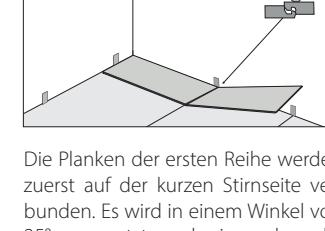
Die empfohlene Verlegerichtung ist längsseitig zur einfallenden Hauptlichtquelle. Als maximale zusammenhängende Verlegefläche empfehlen wir 10,00mtr. x 10,00mtr. Größere Flächen darüber hinaus bedürfen der Absprache und Freigabe durch die Anwendungstechnik. Zu allen aufstrebenden Bauteilen, wie Wände, Säulen oder Türdurchgängen sowie angrenzenden Flächen müssen entsprechende Dehnungsfugen fachgerecht eingebaut werden.
