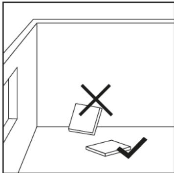
Lagern Sie die Pakete und Paneele niemals aufrecht, sondern flachliegend auf einem ebenen Untergrund, um Verformungen zu vermeiden. Schützen Sie die Paneele vor Feuchtigkeit. Ausdehnung und Schrumpfung erfolgen unter veränderlichen Feuchtigkeitsbedingungen. Feuchtigkeit begünstigt Schimmelbildung.
