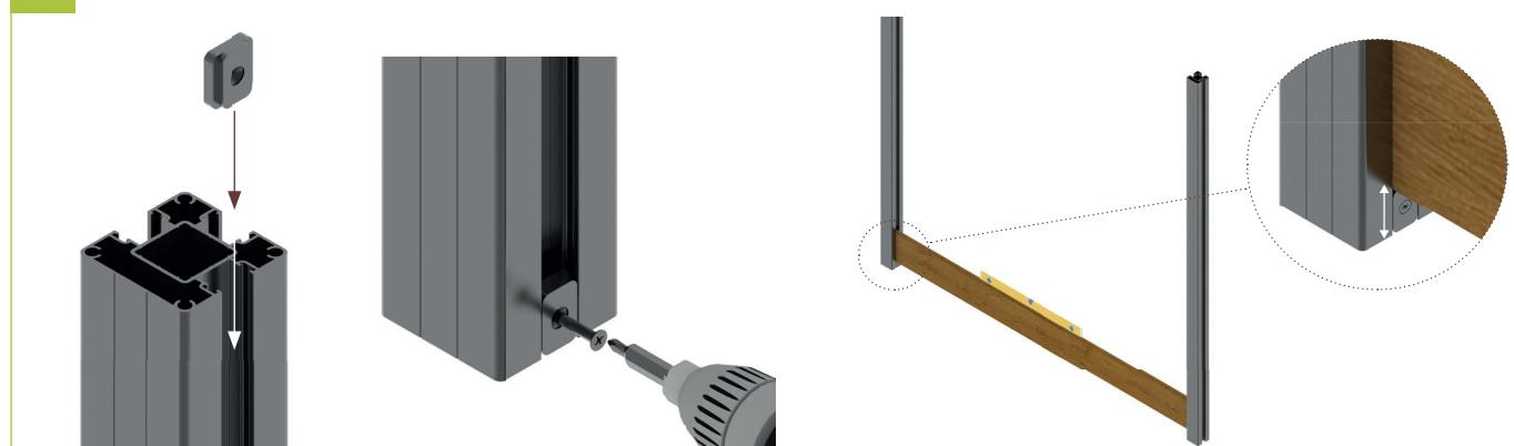
4 | Distanzstück hochkant in die Innenseite der Pfostennut einschieben, bündig mit der Unterkante des Pfostens abschließen, vorbohren und verschrauben. Zuerst auf einer Seite das Distanzstück befestigen. Das Distanzstück der zweiten Seite mit Hilfe eines Füllungselementes und einer Wasserwaage ausrichten und befestigen
