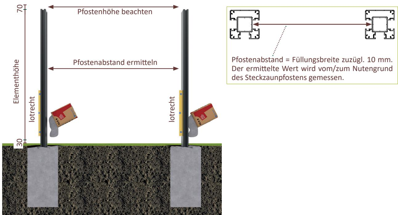
3 | Anschließend die Pfosten setzen und ausrichten. Das Erdloch komplett mit Beton füllen und verdichten. Beton nach Herstellerangaben aushärten lassen.
