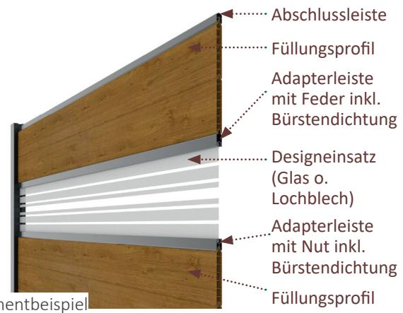
6a | Die Füllungsprofile nacheinander von oben einschieben, dabei die Feder der Füllungsprofile nach oben ausrichten. Bei der Montage des Designeinsatzes vorher die Bürstdichtungen in die Adapterleisten einschieben, dann folgende Reihenfolge beachten: Adapterleiste mit Nut, Designelement, Adapterleiste mit Feder. Danach die verbliebenen Füllungsprofile einschieben und die Abschlussleiste aufsetzen.
