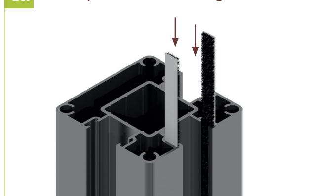
4a | Jeweils zwei Bürstendichtungen in die Pfostennuten einschieben.
