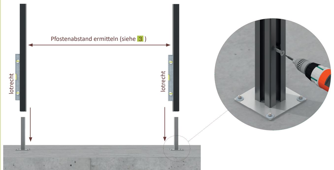
3a | Ausrichtung der Konsolen bei aufgesteckten Pfosten. Zum Befestigen der Konsolen auf den Untergrund die Pfosten entfernen. Zusätzlich kann der Pfosten durch eine Senkkopfschraube fixiert werden. Schrauben sind nicht im Lieferumfang enthalten.
