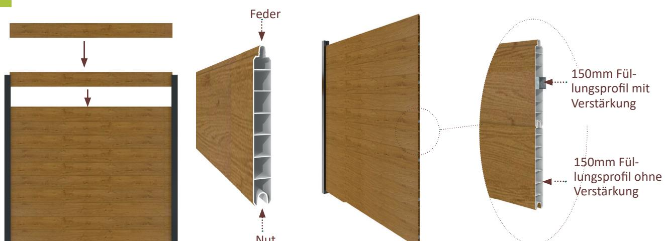
5 | Die Füllungsprofile des Gardence Simply Schmal Elements nacheinander und im Wechsel (Füllungsprofil mit Verstärkung und ohne Verstärkung) von oben einschieben, dabei die Feder der Füllungsprofile nach oben ausrichten. Mit einem Füllungsprofil inkl. Stahlverstärkung beginnen.
