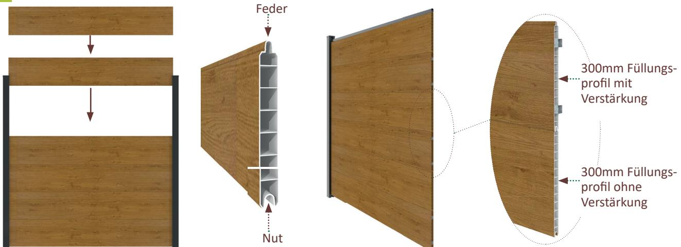
5 | Die Füllungsprofile des Gardence Simply Elements nacheinander und im Wechsel (Füllungsprofil mit Verstärkung und ohne Verstärkung) von oben einschieben, dabei die Feder der Füllungsprofile nach oben ausrichten. Mit einem Füllungsprofil inkl. Stahlverstärkung beginnen.
