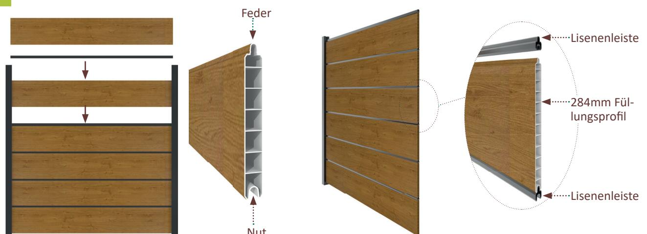
5 | Die Füllungsprofile des Gardence Simply Elements nacheinander und im Wechsel mit den Lisenenleisten von oben einschieben, dabei die Feder der Füllungsprofile nach oben ausrichten. Mit einem Füllungsprofil beginnen.
