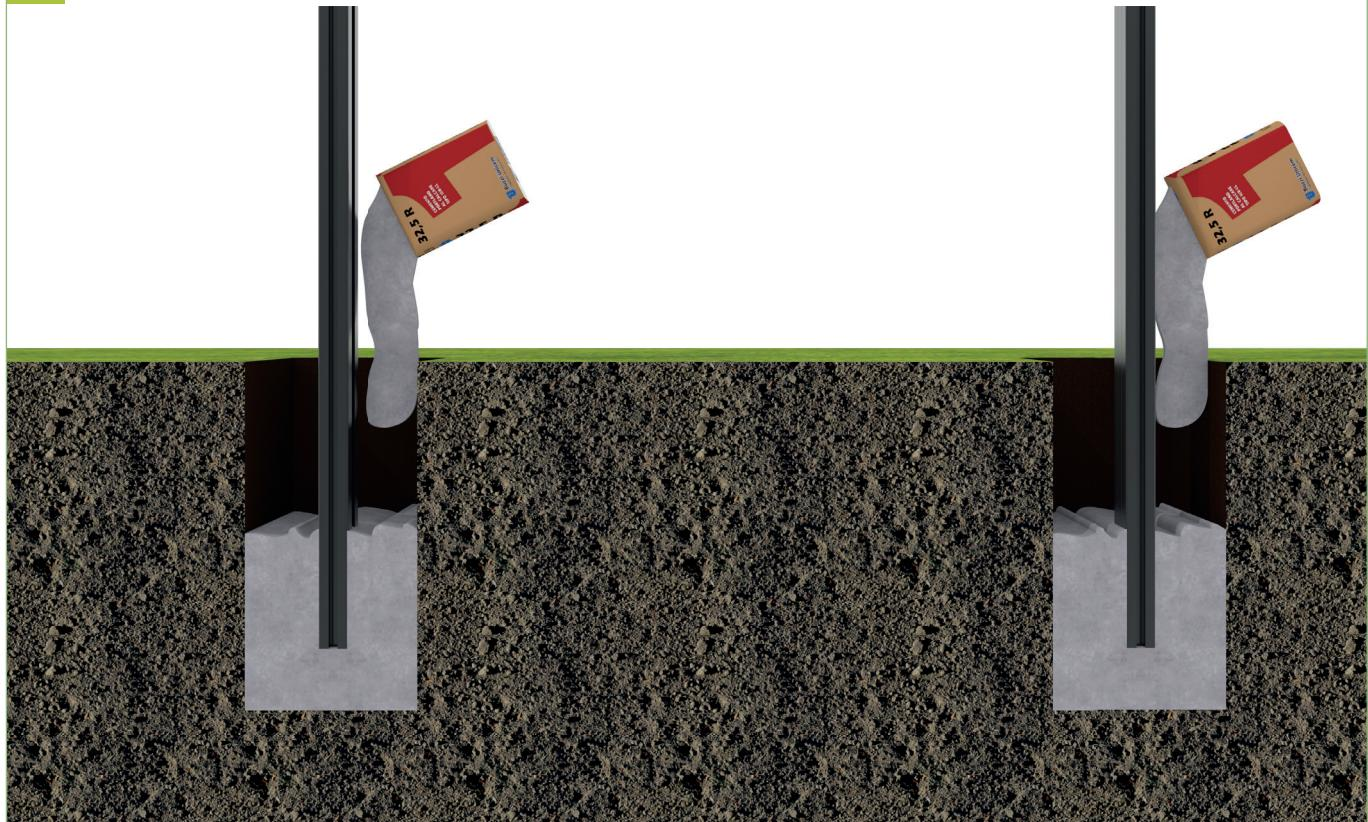
2 | Ungefähr die Hälfte des Erdloches mit Beton füllen und verdichten.
