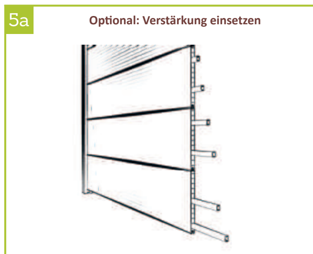
5a | Die Verstärkung in der ersten Füllung im unteren und mittleren Bereich einführen. Die Abstände der Verstärkung für das zweite und dritte Steckzaunprofil jeweils dritteln.
