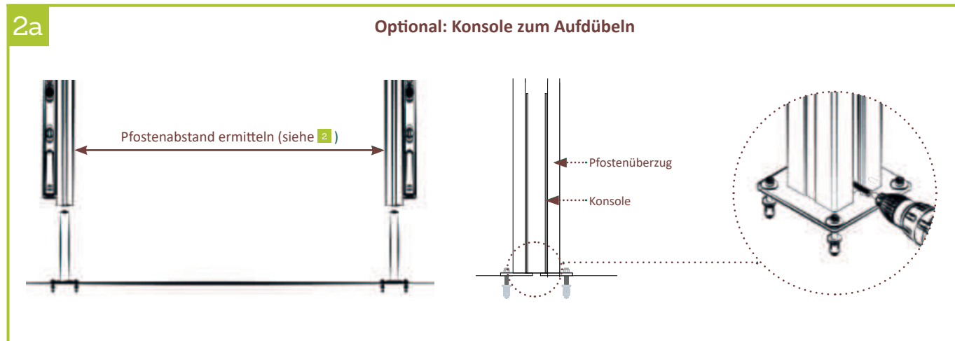
2a | Ausrichtung der Konsolen bei aufgesteckten Pfosten, danach aufdübeln.
