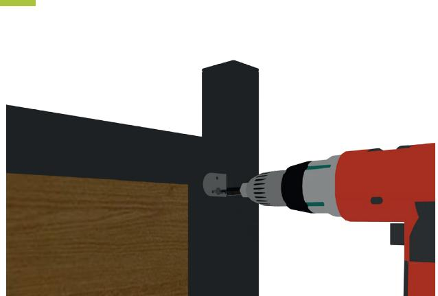
5 | Nach der Montage aller Befestigungswinkel wird das Zaunelement mit jeweils zwei selbstschneidenden Schrauben Ø 3,9 x 13 mm pro Befestigungswinkel mit einem Kreuzschlitz-Bit PH2 rückseitig befestigt.
