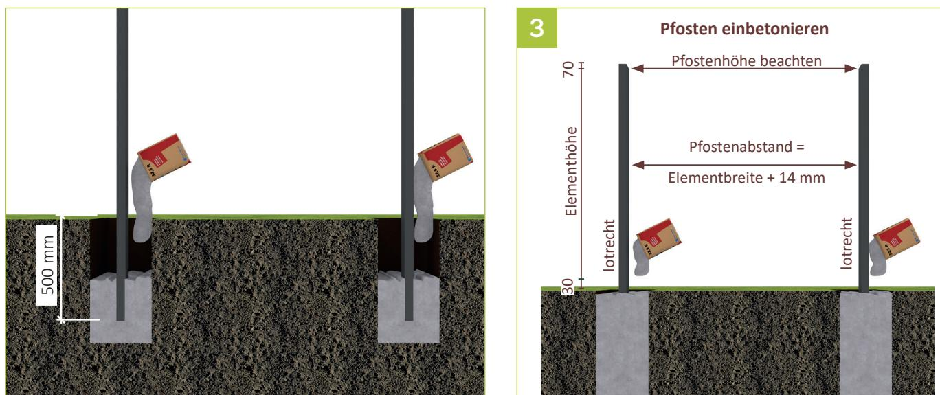
2 | Ungefähr die Hälfte des Erdloches mit Beton füllen und verdichten.
