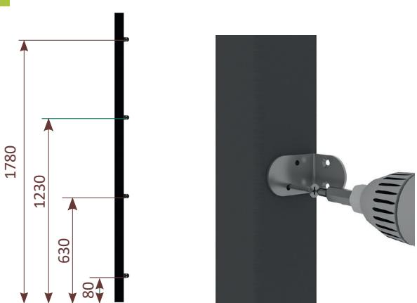
4 | Position der Befestigungswinkel entsprechend der Maßangaben markieren dabei darauf achten, dass das Zaunelement mittig zum Pfosten positioniert ist. Anschließend mit einem 3 mm Bohrer vorbohren (nicht im Set enthalten). Die Befestigungswinkel mit den selbstschneidenden Schrauben Ø 3,9 x 25 mm mit einem Kreuzschlitz- Bit PH 2 am Pfosten montieren.
