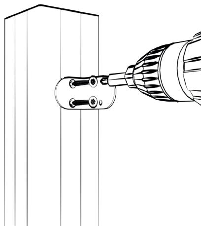
3a | Die Befestigungswinkel werden mit je zwei langen Schrauben am Pfosten und je zwei kurzen Schrauben an den Querriegeln der Zaunelemente befestigt. Die Befestigungswinkel mittig vom Querriegel anbringen.
