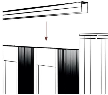
4 | Die Abdeckleiste von oben auf das Element setzen.
