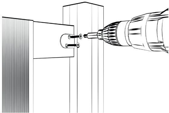
3c | Die Befestigungswinkel werden von hinten mittig an dem Aluminiumquerriegel befestigt. Die Schraublöcher mit einem 3 mm Bohrer vorbohren!
