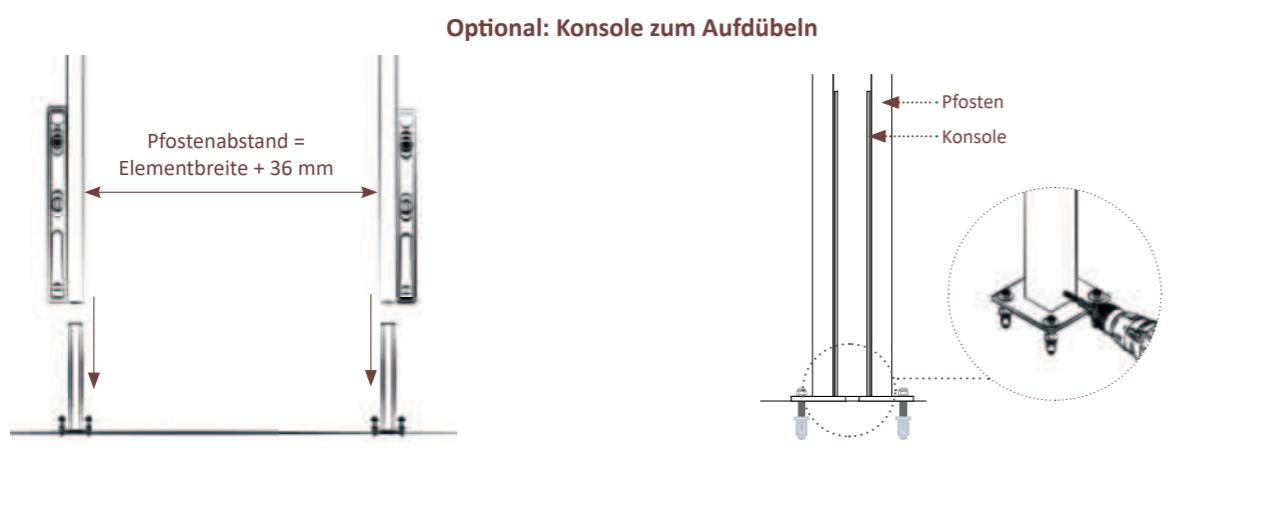
2a | Ausrichtung der Konsolen bei aufgesteckten Pfosten, danach aufdübeln\*.
