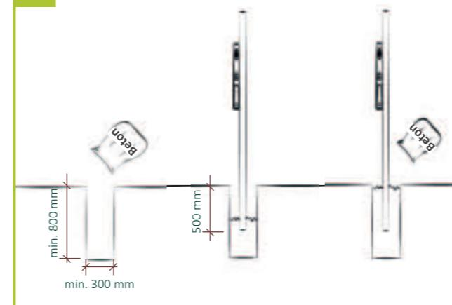
1 | Größe der Fundamente mindestens 300 x 300 x 800 mm sowie unter Berücksichtigung der Bodenbeschaffenheit.\* Ungefähr die Hälfte des Erdloches mit Beton füllen und verdichten. Anschließend die Pfosten setzen und ausrichten. Das Erdloch komplett mit Beton füllen und verdichten.
