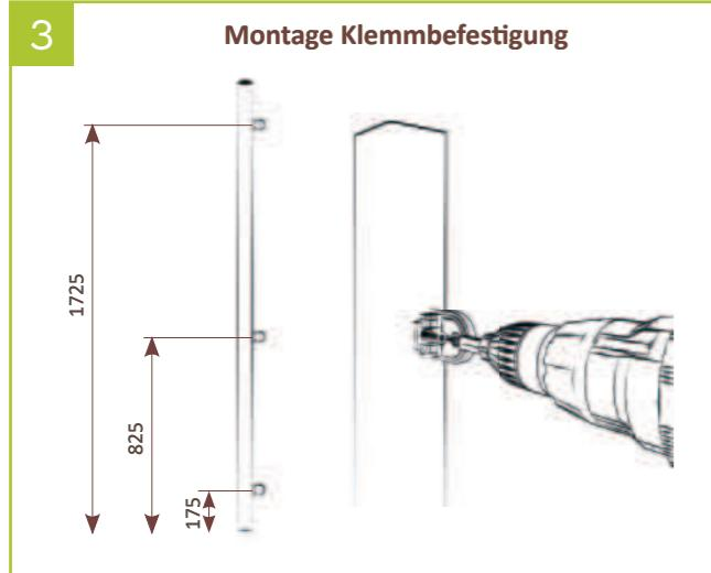
3 | Die Klemmbefestigung mit den beiliegenden Schrauben am Pfosten montieren!
