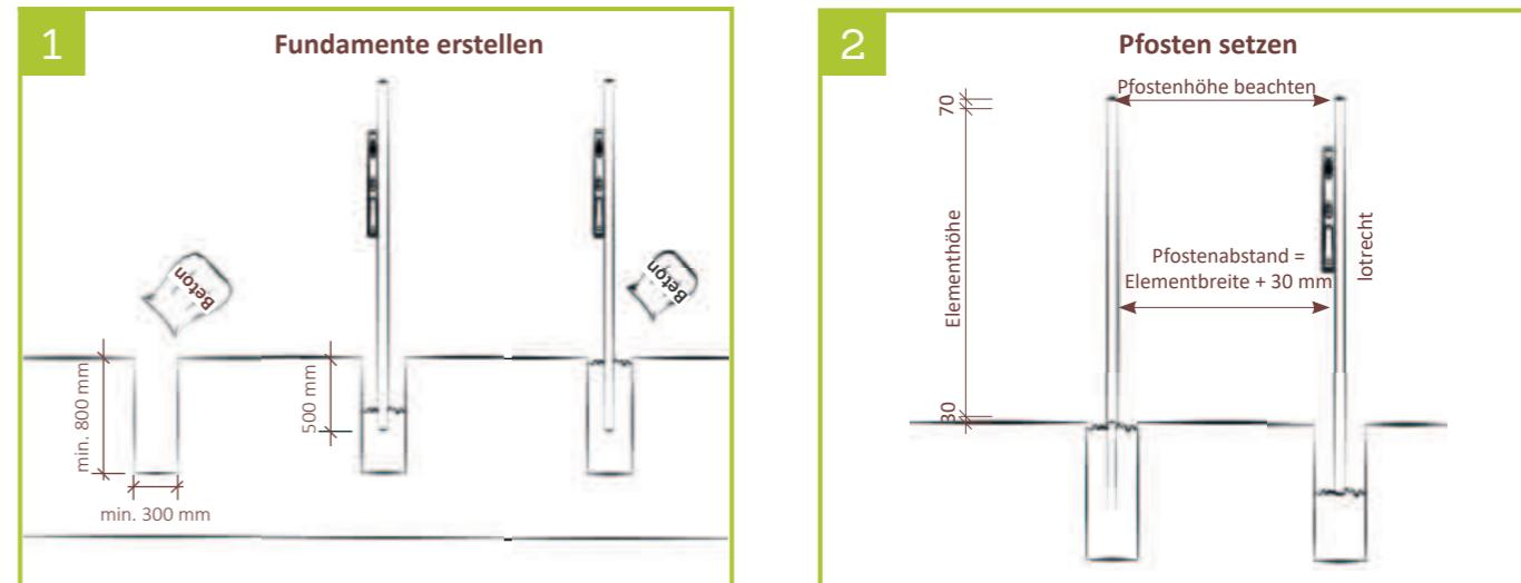
1 | Größe der Fundamente mindestens 300 x 300 x 800 mm sowie unter Berücksichtigung der Bodenbeschaffenheit.\* Ungefähr die Hälfte des Erdloches mit Beton füllen und verdichten. Anschließend die Pfosten setzen und ausrichten. Das Erdloch komplett mit Beton füllen und verdichten.
