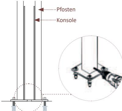
2a | Ausrichtung der Konsolen bei aufgesteckten Pfosten, danach aufdübeln\*.
