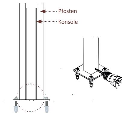
2a | Ausrichtung der Konsolen bei aufgesteckten Pfosten, danach aufdübeln\*.
