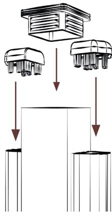
5 | Zum Schluss die Kappen auf die Pfosten und Klemmschienen setzen.
