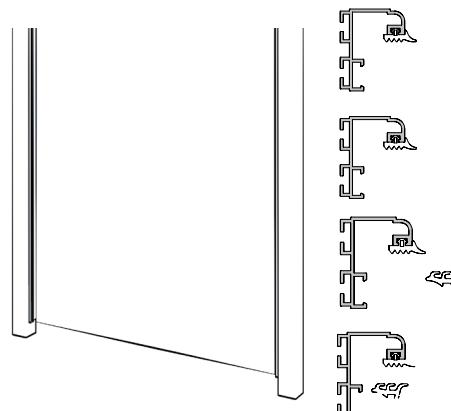
4 | Das Element mittig zwischen den Klemmschienen auf den Aluminium-Auflagewinkeln vorsichtig positionieren. Die Leiste mit der Rastnase in die Klemmschiene einklippen und nach vorne schwenken, bis die vordere Rastnase einrastet. Danach die Dichtung wie dargestellt einschieben.
