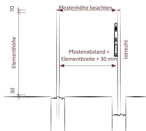
1 | Größe der Fundamente mindestens  $300 \times 300 \times 800$  mm sowie unter Berücksichtigung der Bodenbeschaffenheit.\* Ungefähr die Hälfte des Erdloches mit Beton füllen und verdichten. Anschließend die Pfosten setzen und ausrichten. Das Erdloch komplett mit Beton füllen und verdichten.
