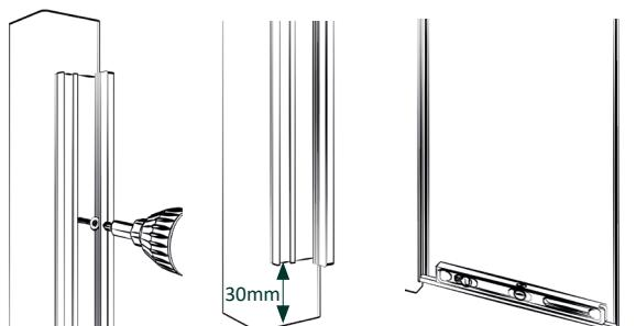
3 | Die Klemmschiene wird mittig mit einem unteren Abstand von 30 mm auf den Pfosten befestigt. Die Schraublöcher bitte mit einem 3 mm Bohrer vorbohren! Die zweite Klemmschiene am gegenüber stehenden Pfosten mit Hilfe einer Holzleiste und einer Wasserwaage befestigen.
