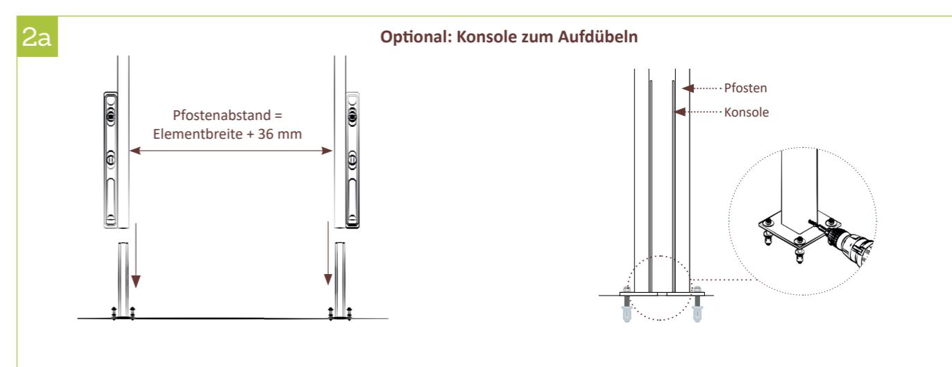
2a | Ausrichtung der Konsolen bei aufgesteckten Pfosten, danach aufdübeln\*.
