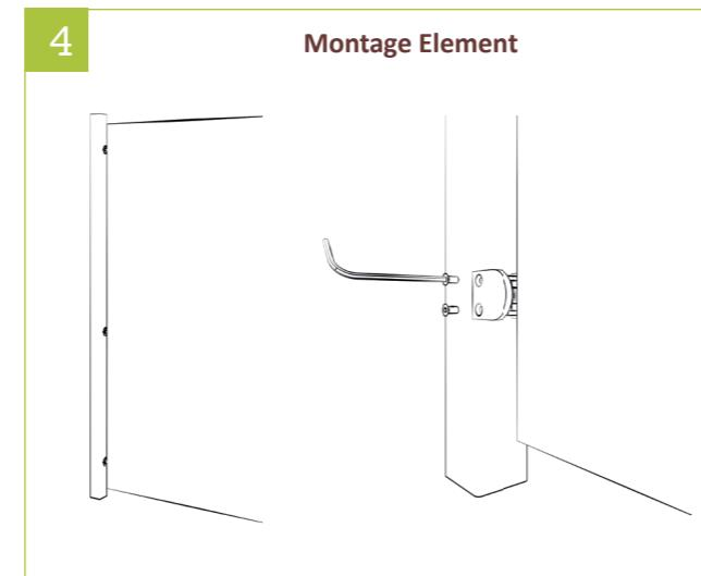
4 | Das Element mittig zwischen der Klemmbefestigung vorsichtig positionieren. Zum Schluss den Grundkörper der Klemmbefestigung mit zwei Innensechskantschrauben auf die Klemmbefestigung montieren.
