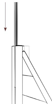
7 | Die Pfostenabdeckleisten von oben in die Pfostennut einschieben und mit der Unterkante des Pfostens bündig abschließen.
