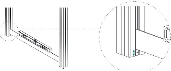
4 | Zuerst auf einer Seite das Distanzstück befestigen. Das Distanzstück der zweiten Seite mit Hilfe eines Füllungselementes und einer Wasserwaage ausrichten und befestigen.
