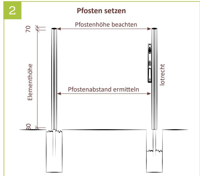
1 | Größe der Fundamente mindestens 400 x 400 x 800 mm sowie unter Berücksichtigung der Bodenbeschaffenheit.\* Ungefähr die Hälfte des Erdloches mit Beton füllen und verdichten. Anschließend die Pfosten setzen und ausrichten. Das Erdloch komplett mit Beton füllen und verdichten.
