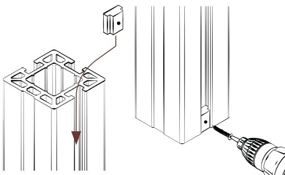
3 | Distanzstück hochkant in die Innenseite der Pfostennut einschieben, bündig mit der Unterkante des Pfostens abschließen, vorbohren und verschrauben.
