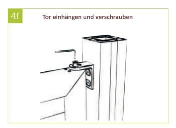
4f | Das Tor (Gehflügel) ausrichten und den oberen Lagerzapfen mittels Senkschraube befestigen.
