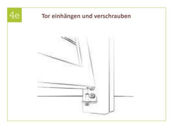
4e | Das Tor (Gehflügel) auf dem unteren Torlager positionieren
