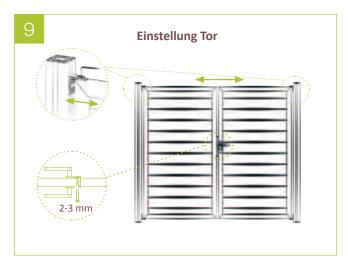
9 | Zur genauen Einstellung lässt sich das Tor durch die verstellbaren Torbänder in die gewünschte Position bringen.
