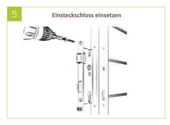
5 | Das Einsteckschloss einsetzen und dessen Position ausrichten, sodass der Schließzylinder und der Griff hineinpassen. Anschließend mit den beigelegten Schrauben befestigen.
