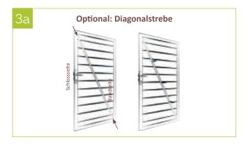
3a | Diagonalstrebe auf der gewünschten Seite des Tores von unten Bandseite, nach oben zur Schlossseite positionieren! Alle drei Löcher anzeichnen und Diagonalstrebe wieder herausnehmen.
