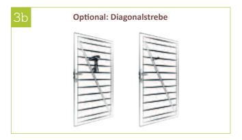
3b | Mit einem 4,5 mm Bohrer durch die erste Wandung der WPC- Füllung bohren, dann die Kunststoffdübel vorsichtig bündig einschlagen. Die Diagonalstrebe wieder einsetzen und mit den mitgelieferten Schrauben von Hand befestigen.
