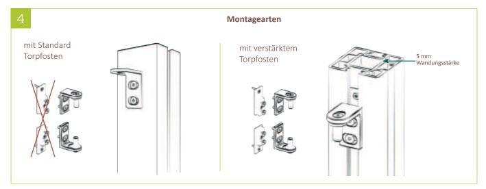
4 |Bei den Standard Torpfosten bitte die Torbänder ohne Nutenstein verwenden. Bei der Montage des verstärkten Torpfostens mit 5 mm Wandungsstärke die Torbänder mit Nutenstein verwenden und Schritt 12 folgen.
