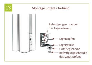
13 | Lagerwinkel mit Senkschrauben M8x25 an den Nutenstein befestigen und mittig ausrichten. Anschließend den Lagerzapfen mit der Sechskantschraube M8x20 und der Unterlegscheibe an den Lagerwinkel befestigen und die äußere Position einstellen.
