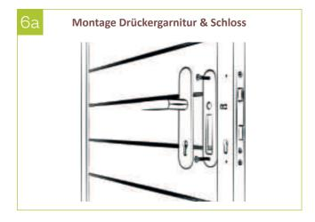
6a | Türdrücker innen einsetzen und anschrauben. Anschließend mit dem Türschild abdecken.
