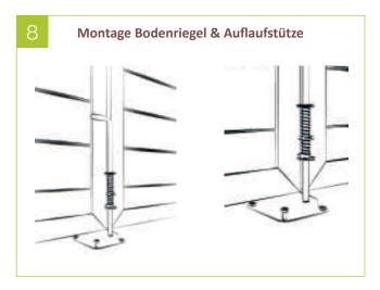
8 | Die Auflaufstütze mit vier Sechskantschrauben auf einen festen Untergrund (Betonsockel) verschrauben. Den Bodenriegel passend zur Auflaufstütze montieren.
