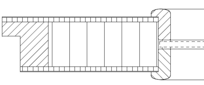
Bei werkseitigen verglasten Türblättern ist das Glas incl. Vorlegeband eingesetzt. Die Glasleisten sind gestiftet. Rechteckige Sonderlichtausschnitte sind möglich, Friesbreiten mindestens 125mm, Sockelhöhe mindestens 200mm (ohne Garantie auf Stehvermögen). Abweichende Formen auf Anfrage. Bei Kürzung der Türen > 10mm könnten Metallklammern erreicht werden. Die F&P GmbH übernimmt für Weiterverarbeitung seiner Produkte grundsätzlich keine Gewähr.
