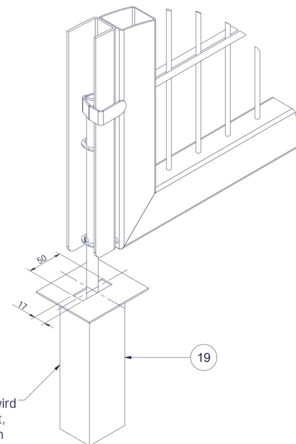
Bitte beachten Sie: Die Bodenhülse wird oberflächenbündig einbetoniert, dass sie mittig unter dem Feststeller des Standflügels sitzt. Wichtig ist, dass das 17x50mm Langloch quer zur Einfahrt steht.
