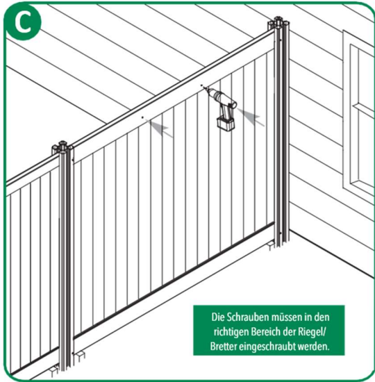
Platzieren Sie zwei 1,25-Zoll-Schrauben im oberen Riegel.
